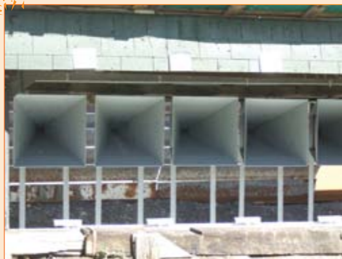
Les cônes récupèrent les projectiles
